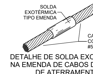
DETALHE DE SOLDA EXOTÉRMICA NA EMENDA DE CABOS DA MALHA DE ATERRAMENTO
